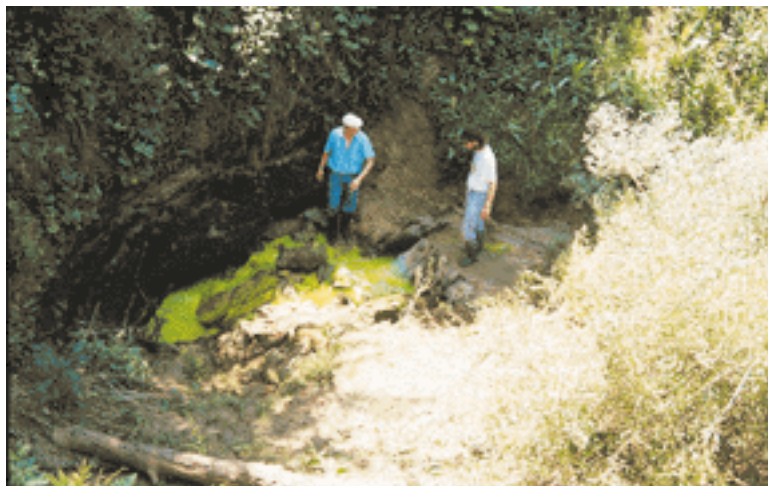
Photo 9 Injection de fluorescéine dans une perte Réseau de la Carbone de Menouille Cernon (39)
