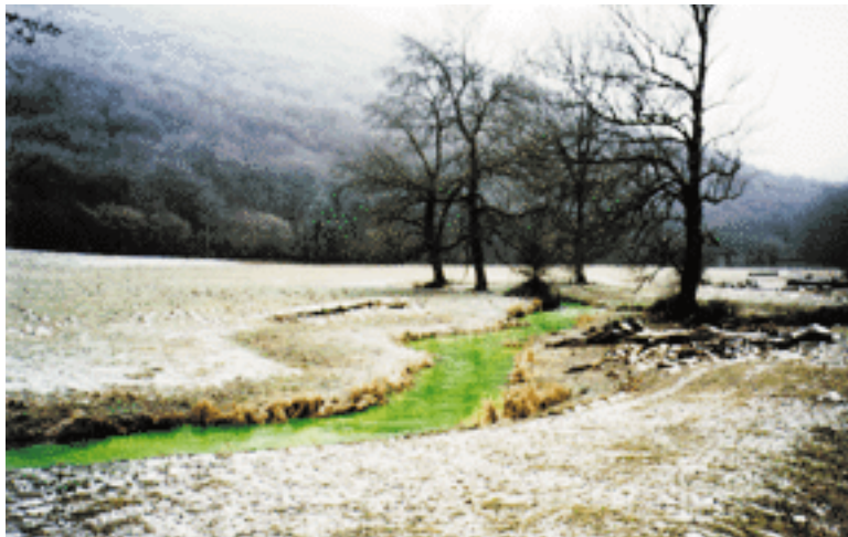
Photo 10 La restitution du traceur (fluorescéine) Ruisseau du Rhoin Bouillant (21)
